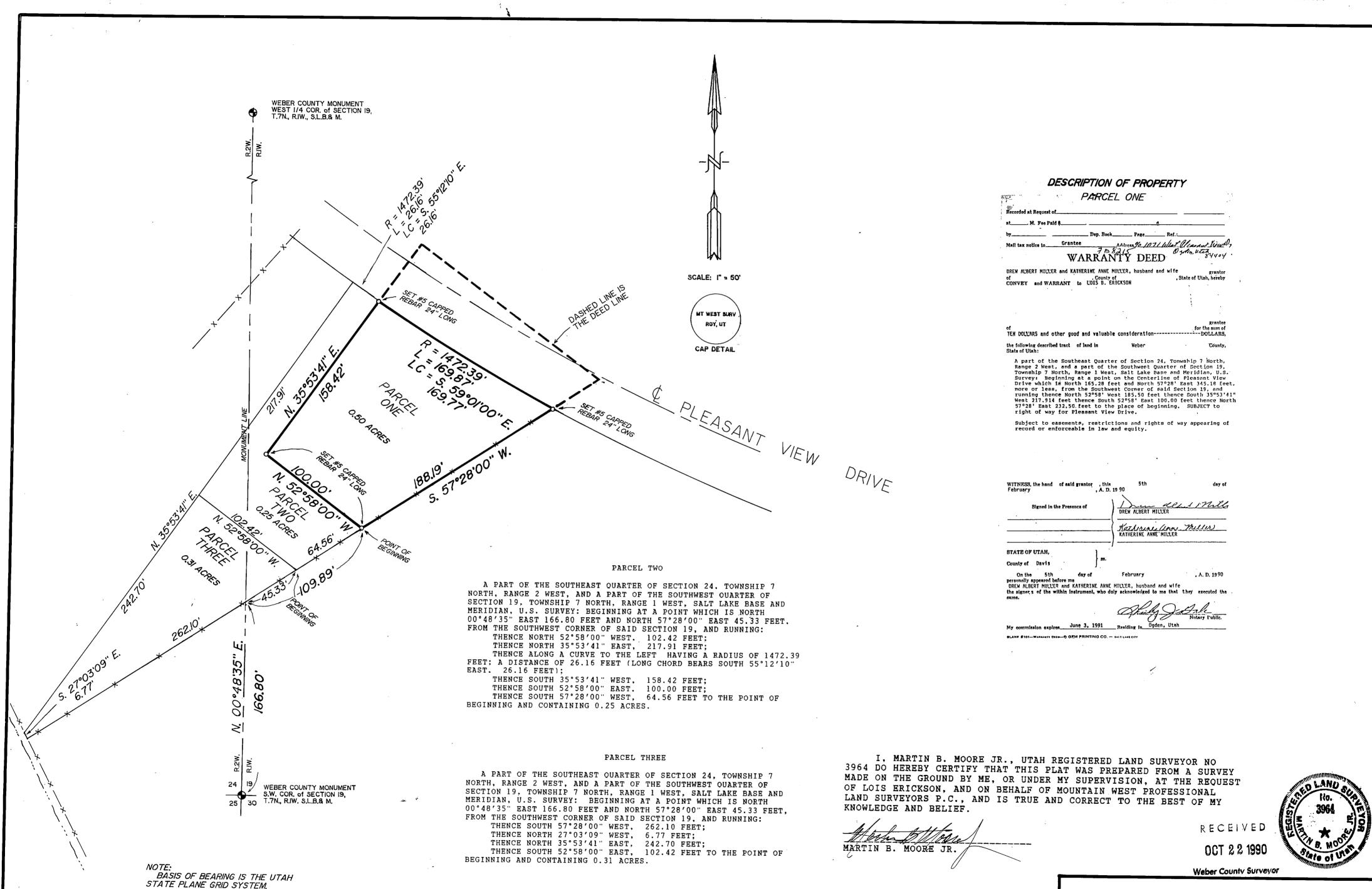
THE PURPOSE OF THIS SURVEY WAS TO LOCATE AND MARK THE DESCRIBED PROPERTY ON THE GROUND. THE BEARINGS GIVEN IN THE DEED WERE LEFT INTACT TO THE UTAH STATE PLAIN GRID BEARING SYSTEM. AS OCCUPATION HARMONIZED WITH DEED. THE BEGINNING POINT IN THE CENTER OF PLEASANT VIEW DRIVE WAS CONFIRMED TO TOLERANCE, ACTUAL LOCATION IS AS SHOWN. THE DEED CALLS FOR PART OF THE PARCEL TO BE IN
